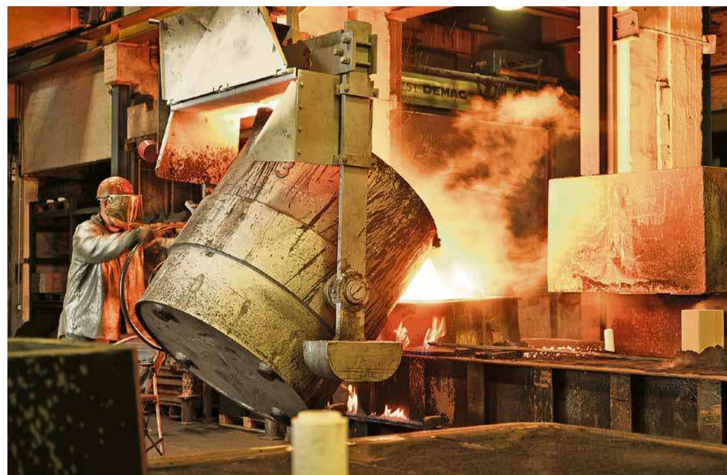
Mit Elektroöfen wird in der Kemptener Eisengießerei das Roheisen geschmolzen. Foto: Kemptener Eisengießerei Adam Hönig AG
