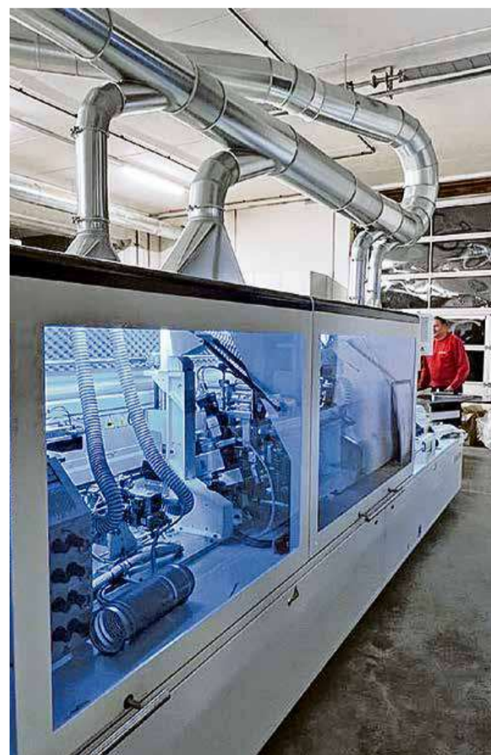
Die neue Kantenanleimmaschine ermöglicht das präzise Bearbeiten von Kanten aller Art.
